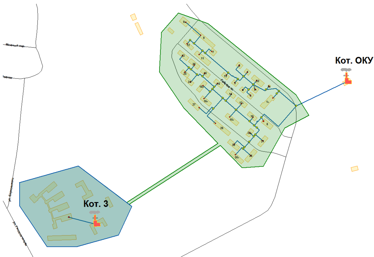
Рис. 3.1. Перспективная зона действия котельной №3
