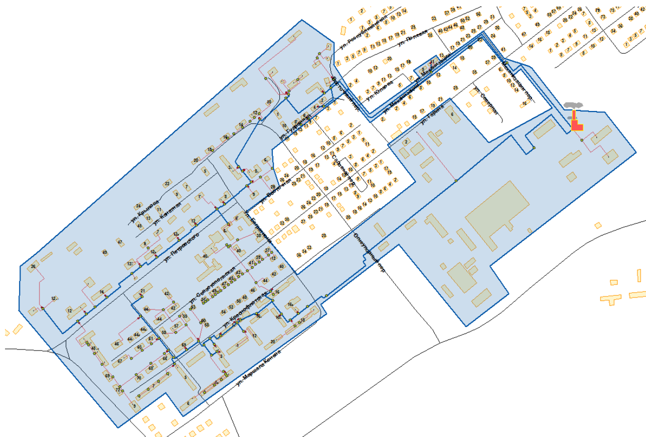
Рис. 2.8. Зона действия котельной №6 (существующая зона действия выделена синим, перспективная - красным)
