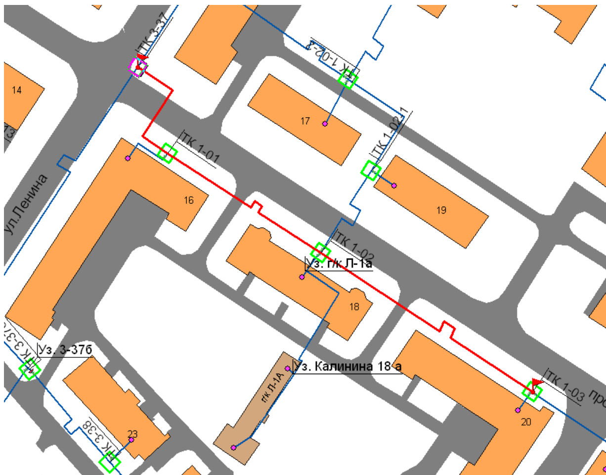
Рис. 5.2.7. Участок тепломагистрали отТК3-37 до ТК 1-03
