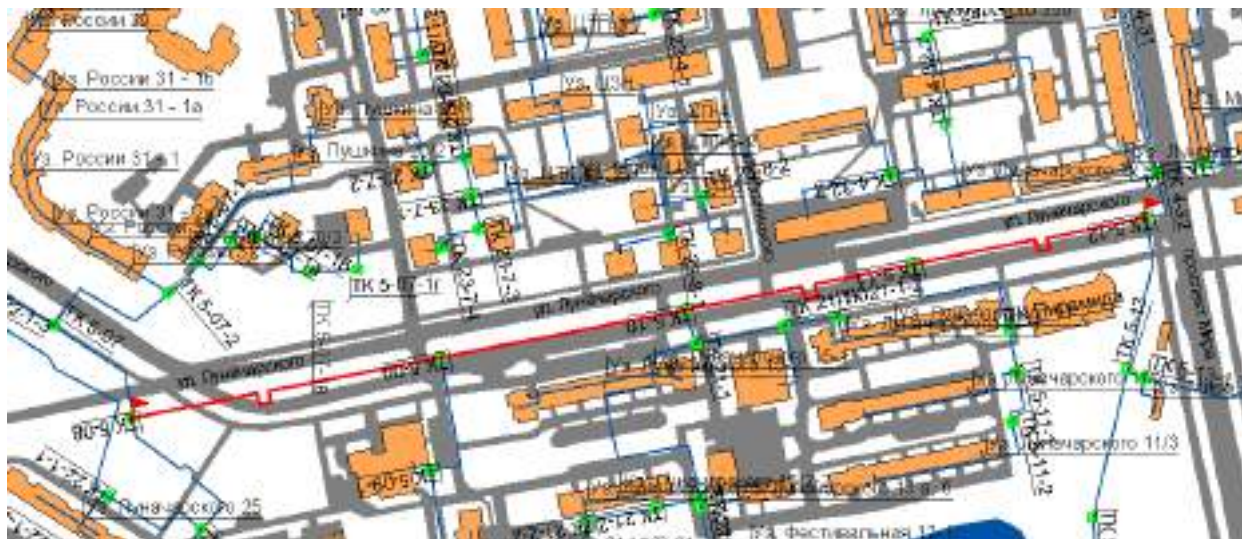
Рис. 5.2.3. Участок тепломагистрали Ø 500 от ТК5-08 до ТК5-12
