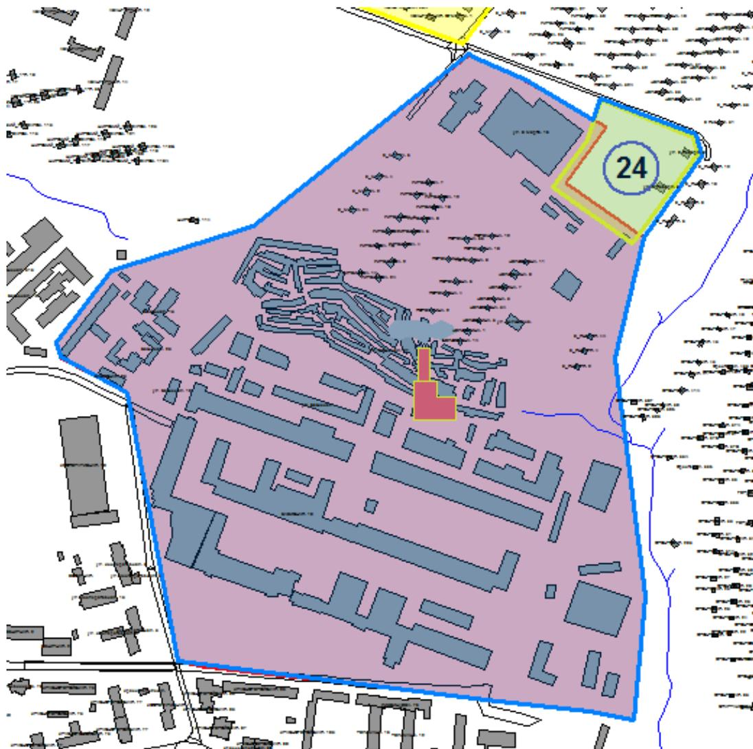
**Рис. 2.17. Существующая (выделена красным цветом) и перспективная (выделена синим цветом) зоны действия котельной АО «ИРЗ – энерго» с указанием расположения площадок новой застройки (выделены жёлтым)**
