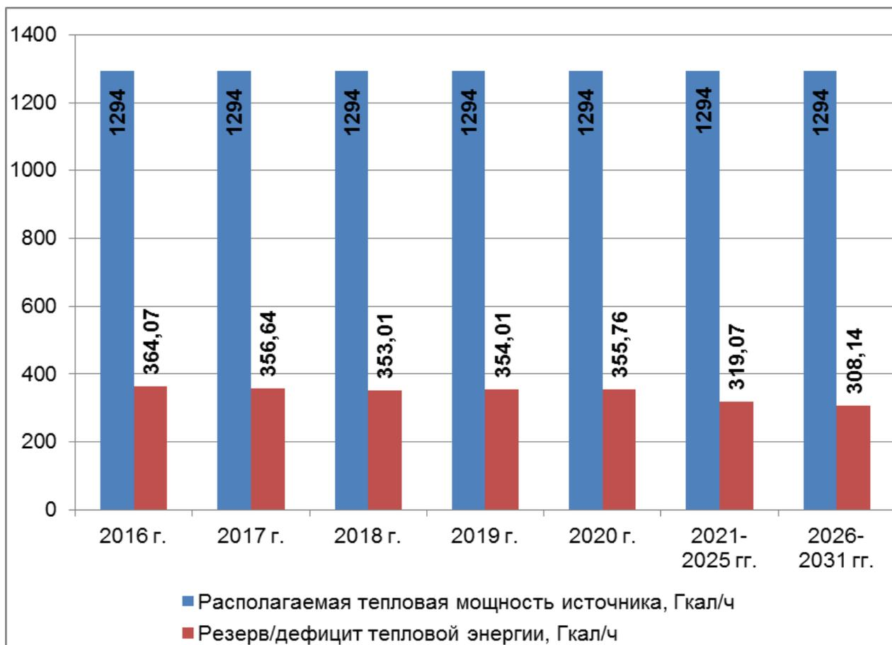
Рис. 2.6. Сопоставление располагаемой тепловой мощности и резерва тепловой энергии Ижевской ТЭЦ-2
