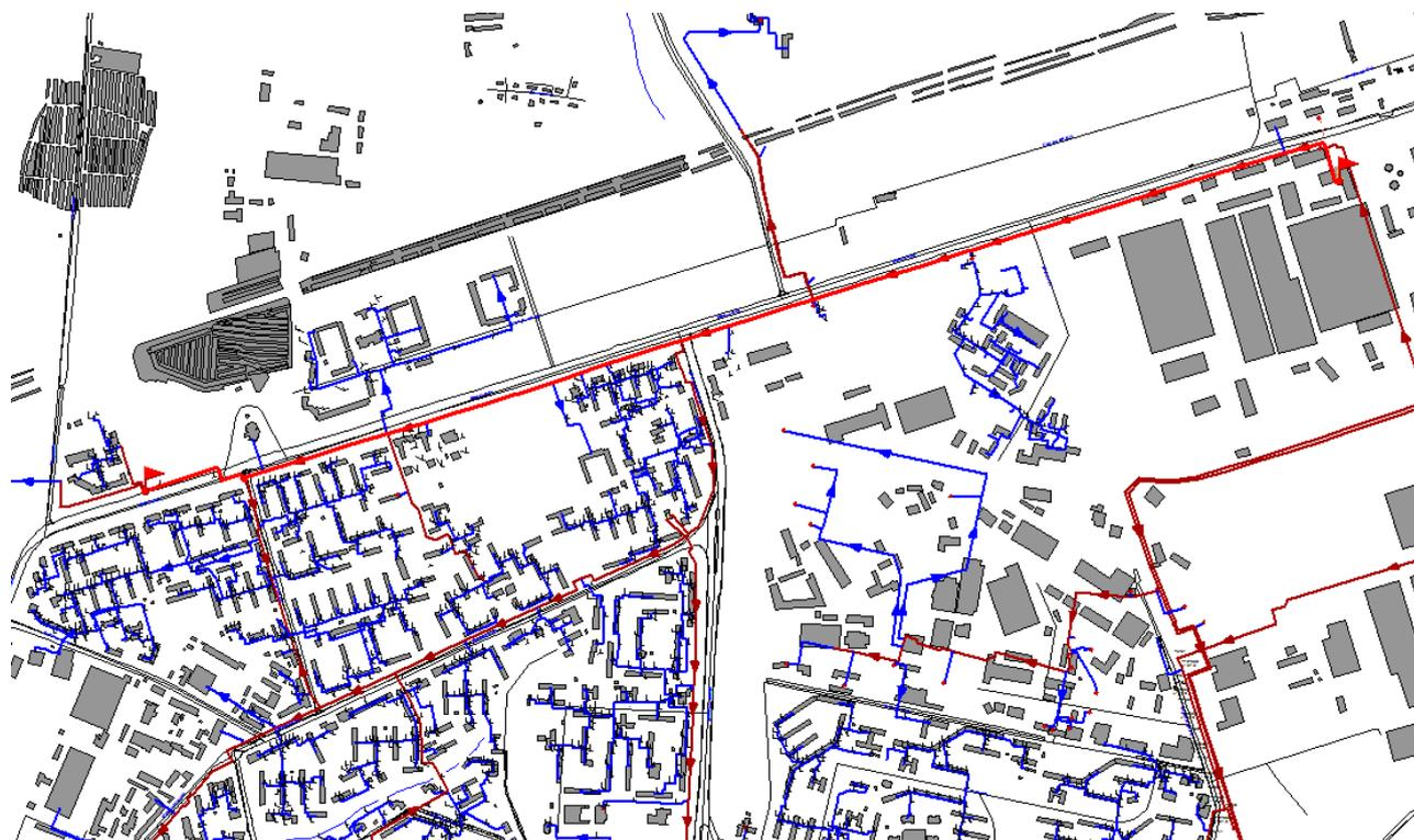
Рис. 4.4.1. Расчетная схема участка тепловой сети от котельной ОАО «Ижметмаш» до ТК-2131/4
