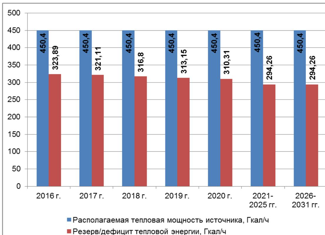
Рис. 2.8. Сопоставление располагаемой тепловой мощности и резерва тепловой энергии котельной ЗАО «Ижметмаш»
