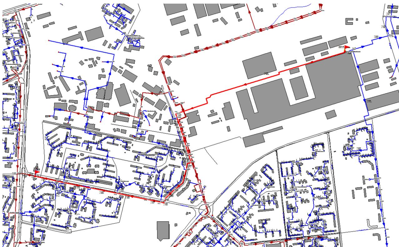
Рис. 4.3.1. Расчетная схема участка тепловой сети от котельной Автозавода до ТК-2055
