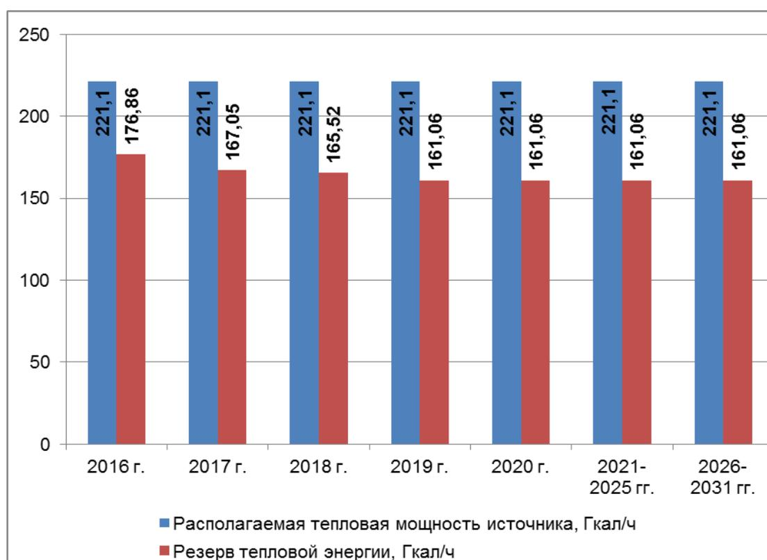
Рис. 2.20. Сопоставление располагаемой тепловой мощности и резерва тепловой энергии котельной ООО «Мечел-энерго»
