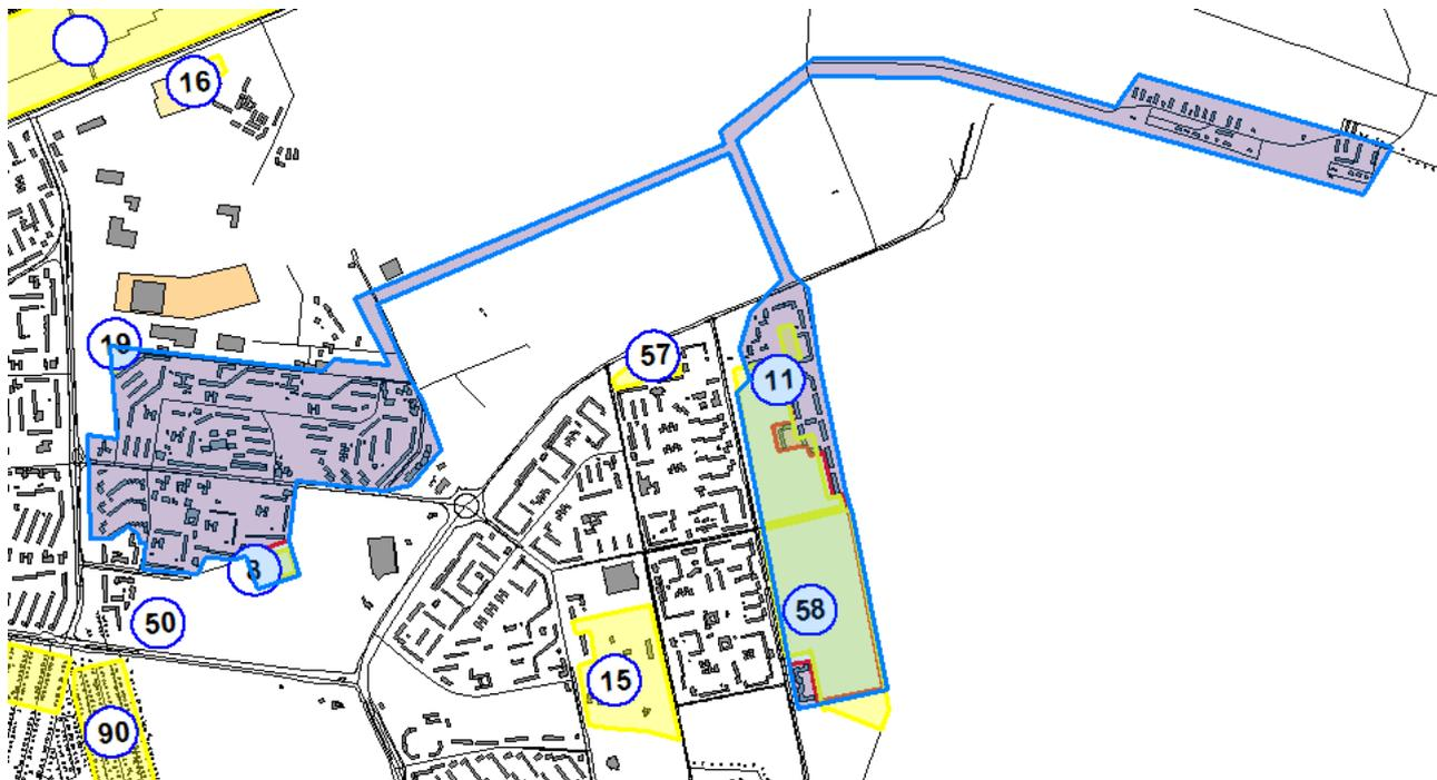
**Рис. 2.11. Существующая (выделена красным цветом) и перспективная (выделена синим цветом) зоны действия котельной ООО «Автокотельная» с указанием расположения площадок новой застройки (выделены жёлтым)**
