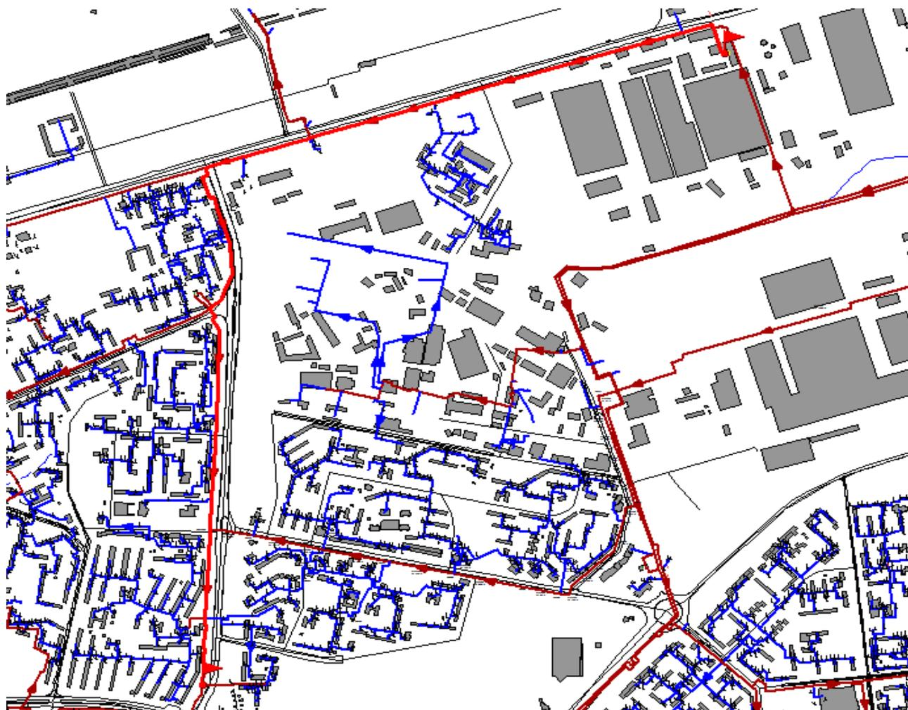
Рис. 4.4.8. Расчетная схема участка тепловой сети от котельной ОАО «Ижметмаш» до ТК-2309
