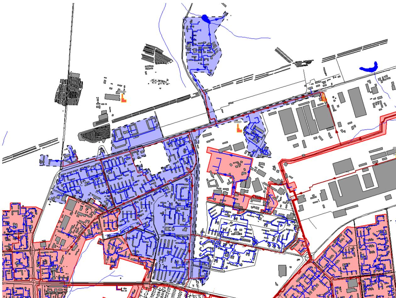
**Рис. 2.2. Зоны действия ТЭЦ-2 (выделена красным цветом) и котельной ЗАО «Ижметмаш» (выделена синим цветом) с указанием схемы прокладки тепловых сетей**
