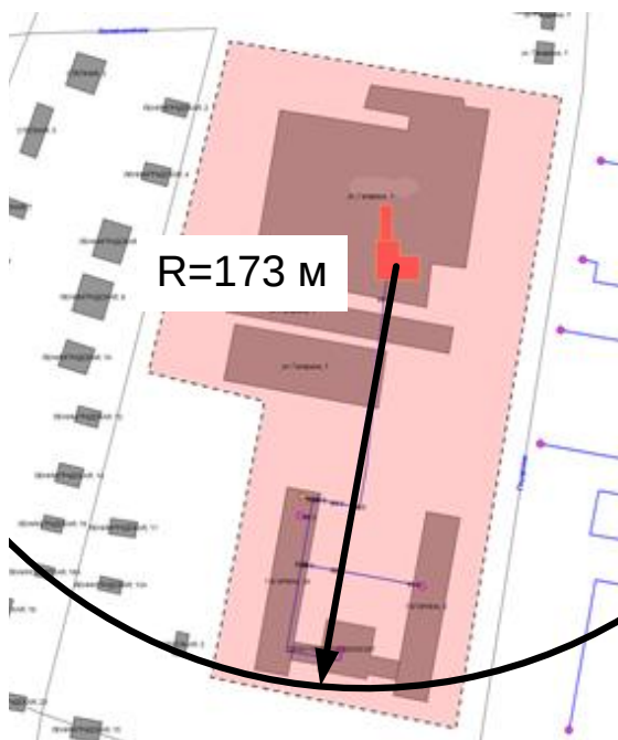
Рис. 3.15.9. Зона действия котельной ОАО «ИПОПАТ» и радиус эффективного теплоснабжения от котельной
