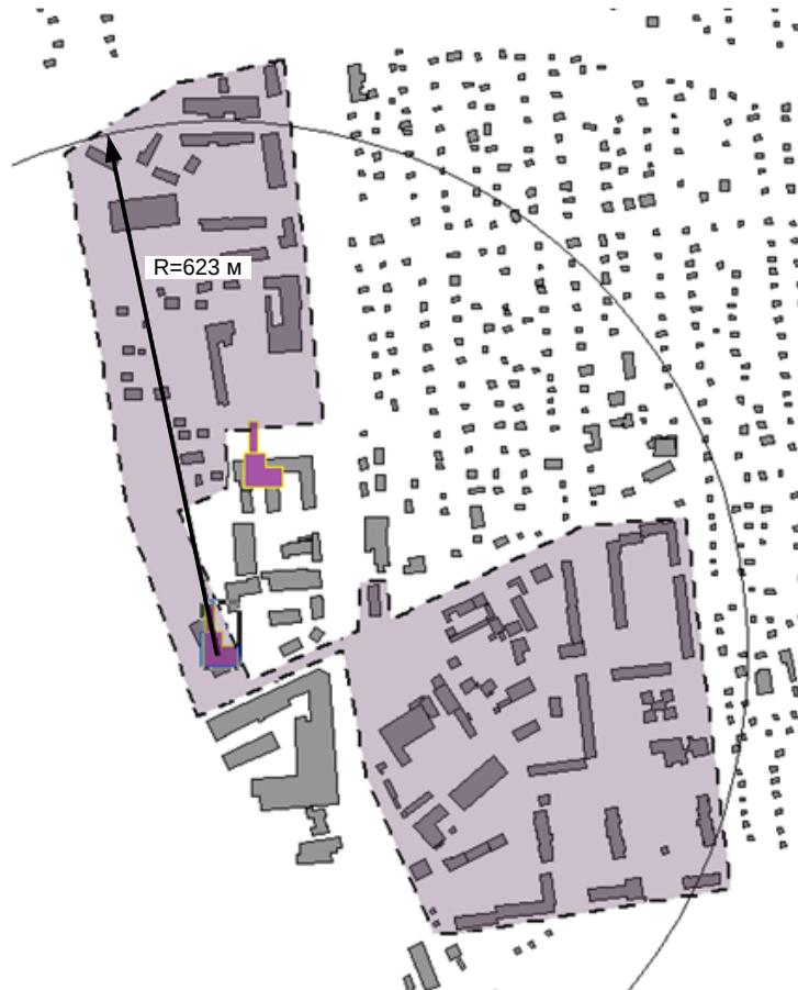
Рис. 3.13.4. Зона действия котельной филиала «УПП № 821» ФГУП «ГУССТ № 8 при ССР»
