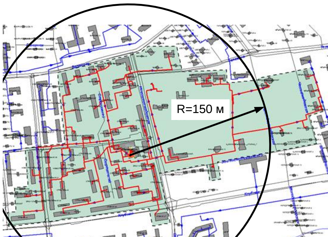
Рис. 3.15.5. Зона действия котельной ООО "БПК" пос. Строителей, 66а и радиус эффективного теплоснабжения от котельной
