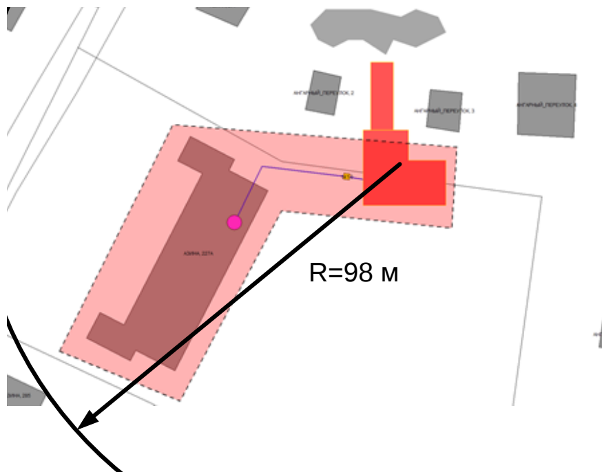
Рис. 3.14.20. Зона действия котельной д/с 107 и радиус эффективного теплоснабжения от котельной
