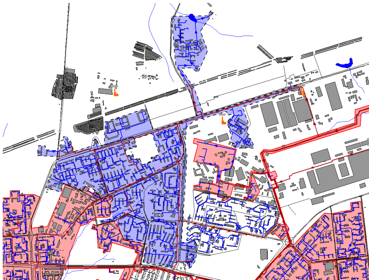
Рис. 2.2.1. Зоны действия ТЭЦ-2 (выделена красным цветом) и котельной ЗАО «Ижметмаш» (выделена синим цветом) с указанием схемы прокладки тепловых сетей
