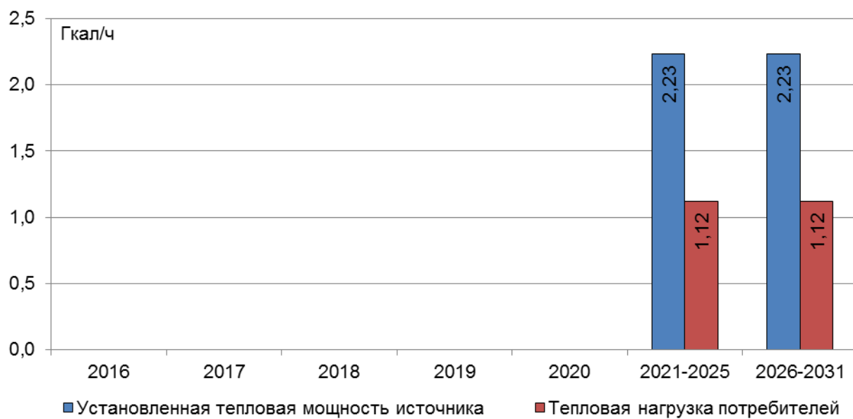
Рис. 4.3.2. Соотношение присоединённой тепловой нагрузки потребителей и установленной тепловой мощности перспективной котельной
