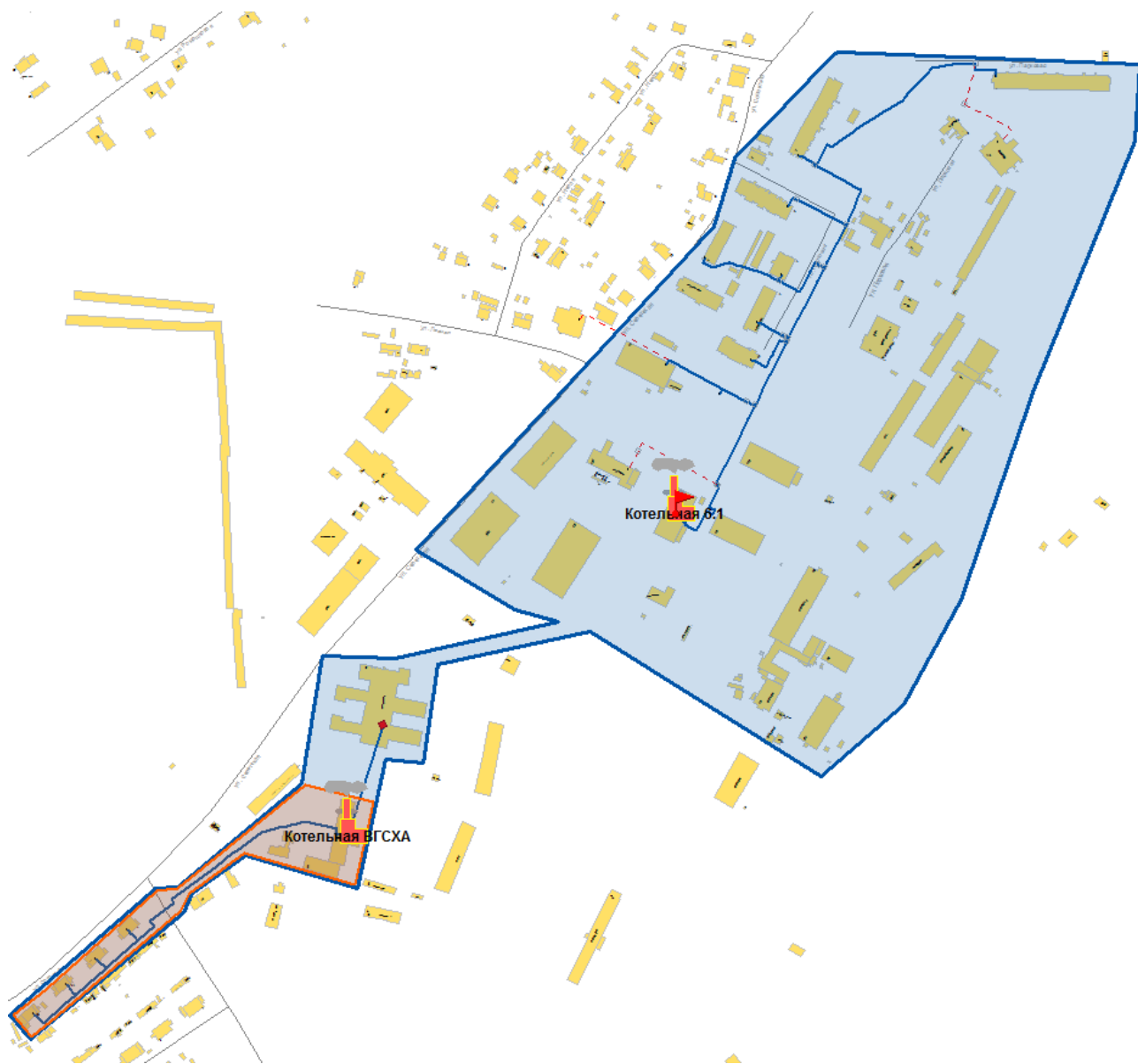
Рис. 3.7.2. Увеличение зоны действия котельной 6.1 (выделена синим) за счет подключения потребителей котельной ВГСХА (зона действия выделена оранжевым)
