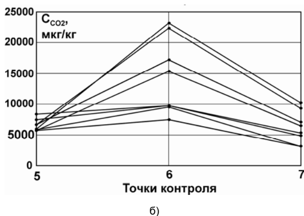
Рис. 1. Изменение массовой концентрации свободного диоксида углерода в воде по элементам деаэрационных колонок деаэраторов ДА-300М (а) и ДСА-300 (б) в условиях опытов ( C_{CO_2} – массовая концентрация свободного диоксида углерода в воде, мкг/кг): 1 и 5 – вода перед деаэратором; 2 и 6 – вода после верхнего струйного отсека; 3 и 7 – вода после нижнего струйного отсека; 4 – вода после несправильного барботажного листа деаэрационной колонки
